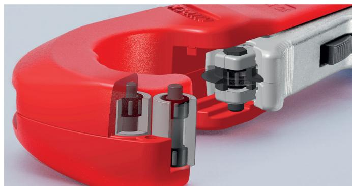
Díky vysoce kvalitním jehlovým ložiskům se řezné kolečko i čtyři vodicí válečky při řezání otáčejí takřka bez obtěžujícího tření – zvlášť snadné řezání trubek z nerezové oceli
