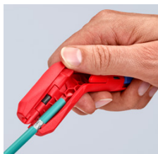
Odizolování datového kabelu
