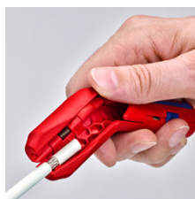
Odizolování koaxiálního kabelu
