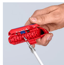
Odizolování koaxiálního kabelu
