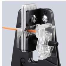
Čisté naříznutí izolace po celém obvodu
